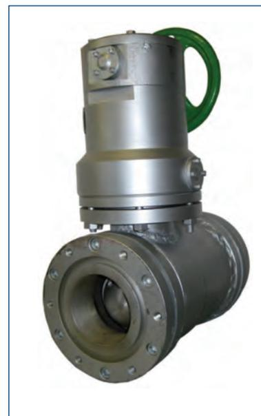
Наконечник штока клапана соединен с сильфоном либо сваркой (стальной сильфон), либо изготовлен из цельного материала (фторопластовый сильфон). Такая конструкция гарантирует полную изоляцию регулируемой среды от управляющего привода. Пружинная конструкция сильфона обеспечивает необходимый ход штока при регулировании процесса.
