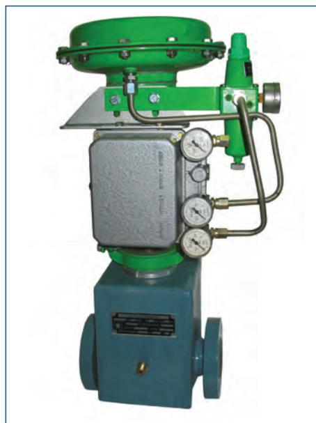
Клапаны с парообогревом КМП предназначены для автоматического управления потоками жидкостей, кристаллизующихся или застывающих в застойных зонах при понижении температуры. Конструкция клапанов КМП рассчитана на обогрев корпуса клапана паром, газами, жидкими средами, или другими теплоносителями.
