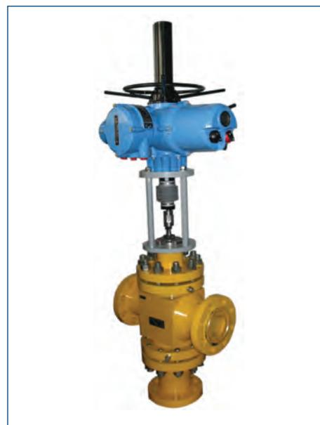
Конструкция смесительного клапана основана на смешивании потоков среды с входов 2 и 3 клапана в пропорциях в соответствии с  $K_{vy}$  плунжера для входов 2 и 3. При открытии или закрытии клапана изменяется расход смешивающихся сред, а пропорции смешивания остаются пропорциональными (соответствующими условной пропускной способности входов клапана).
