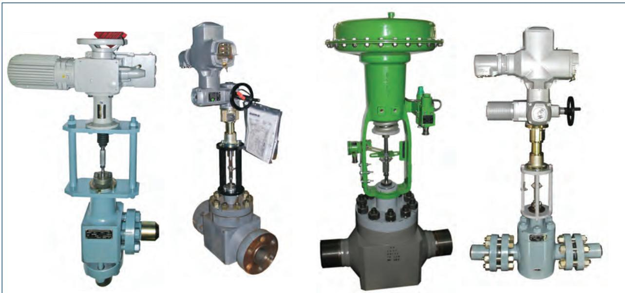
Для обеспечения производственных процессов, где регулируемая среда находится при высоких давлениях (PN) от 25,0 МПа до 40,0 МПа и выше, разработаны клапаны КВД: диаметр условного прохода (DN) от 10 мм до 200 мм, с условной пропускной способностью от 0,006 м<sup>3</sup>/ч до 400 м<sup>3</sup>/ч.
